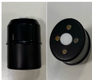
Fig. 8 : Réservoir à fumée
