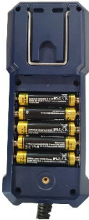
Abb. 4: Rückseite der Bedieneinheit mit geöffnetem Batteriefach
