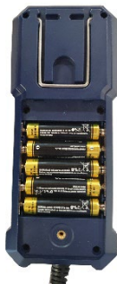
Fig. 12 : Dos de l'unité de commande avec compartiment à piles ouvert
