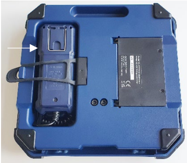
Fig. 11 : Face inférieure de la balance avec unité de commande
