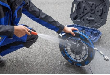
Abb. 58: Abspritzen von Haspel und Stange
