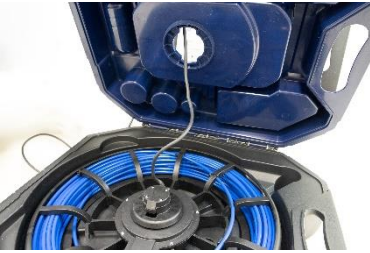
Abb. 61: Falsch: Kamerakabel nicht straff gezogen
