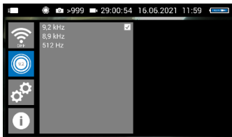
Abb. 33: Ortungssender mit 9,2 kHz Sendefrequenz ausgewählt
