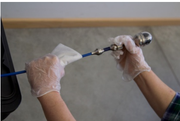
Kamerastange mit Tuch umfassen und in den Koffer zurückschieben
