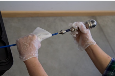
Camerastang met doekje omvatten en in de koffer terugschuiven
