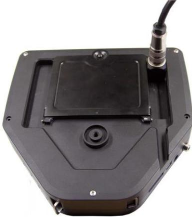
Abb. 9: Anschluss des Kamerakabels
