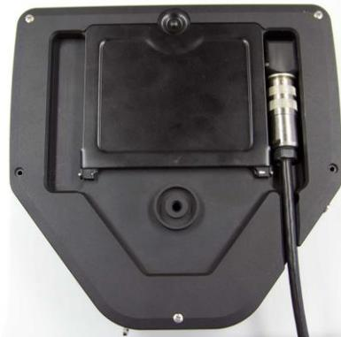
Abb. 10: Kamerakabel durch Führung verlegt
