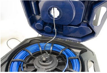
Fig. 58: Incorrect : Le câble de la caméra n'est pas bien tendu
