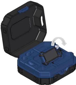
Fig. 10: Le moniteur peut être incliné vers le haut et le bas
