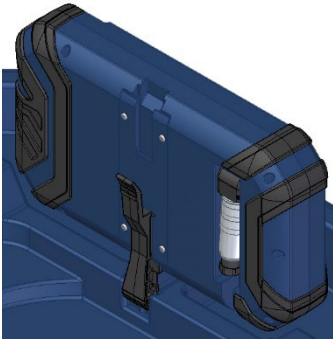
Fig. 51: Appuyez sur le levier et tirez le moniteur hors du support
