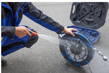
Fig. 55: Nettoyage de l'enrouleur et du jonc au jet d'eau
