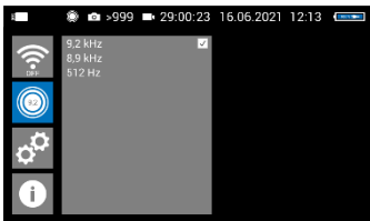
Fig. 31: Sélection de l'émetteur de localisation avec fréquence d'émission de 9,2 kHz
