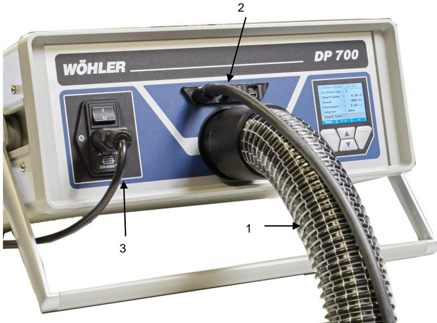
Figura. 2: Collegamento tubo aria senza adattatore
