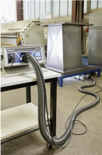
Figura 12: Esempio di prova di tenuta secondo UNI 15727
