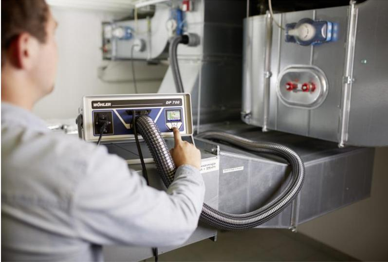
Figura 11: Esempio di misurazione in pressione senza adattatore
