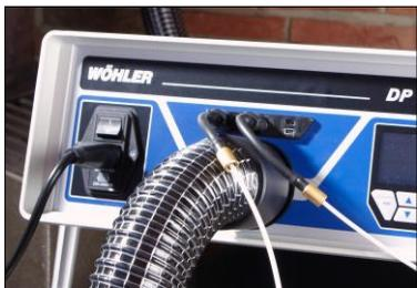
Figura 37: Collegamento dei capillari per la misura della pressione differenziale.
