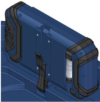
Fig. 54: Premere la leva ed estrarre il monitor
