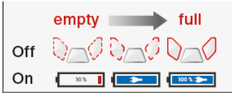
Fig. 15: Pulsanti e indicazione di carica
