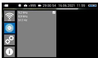
Fig. 33: Locatore testata con frequenza 9,2 kHz
