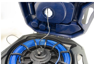
Fig. 61: Errore: Cavo del monitor non estratto a sufficienza
