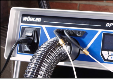
Abb. 37: Anschluss der Kapillarschläuche zur Differenzdruckmessung
