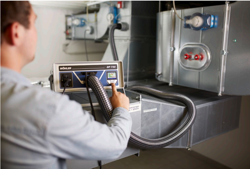
Abb. 11: Beispiel Messaufbau Überdruckmessung ohne Adapter
