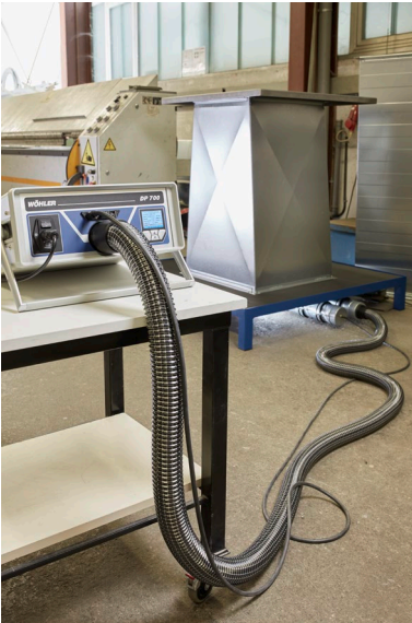
Abb. 12: Beispiel Messaufbau für Messung nach DIN 15727
